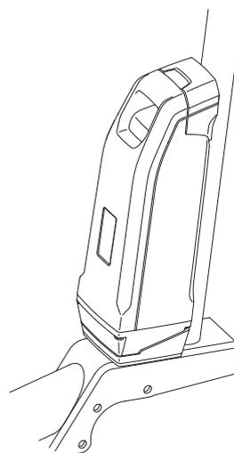
11. Vergewissern Sie sich, dass der Akkupack sicher befestigt ist, indem Sie nach dem Einbau daran ziehen.
