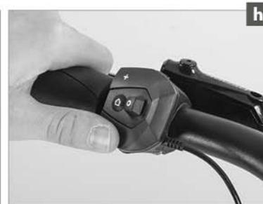
5. Die Funktionen Ihres Pedelecs werden an den Tasten des Bedienelements am Lenker betätigt (g+h, S. 13). Sind Sie mit allen Funktionen und Anzeigen vertraut? Prüfen Sie, ob Sie die Funktionen aller Tasten (a) kennen. Weitere Informationen finden Sie in der Systemanleitung des Antriebsherstellers, z.B. im Kapitel
