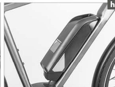
7. Lassen Sie Ihr Pedelec aus geringer Höhe auf den Boden springen. Gehen Sie auftretenden Klappergeräuschen nach. Prüfen Sie ggf. Lager, Schraubverbindungen und den korrekten Sitz des Akkus (h, S. 31) und der Stecker (a+b).
