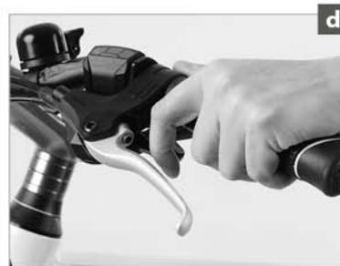
3. Avete già preso confidenza con l'impianto frenante? Consultate il certificato della bicicletta e verificate se riuscite ad azionare il freno della ruota anteriore con la stessa leva del freno (b) (destra o sinistra) che siete soliti usare. Qualora non fosse così, prima della prima uscita fate modificare le leve dal vostro rivenditore autorizzato.
