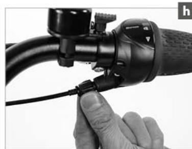
Controllate nuovamente che le linee di contrassegno siano ancora allineate una sopra l'altra. Potrebbe essere necessario correggere di nuovo leggermente la regolazione. A tal fine, girate di nuovo gradualmente la vite di regolazione del tirante sulla manopola del cambio in senso orario o antiorario fino ad allineare le linee di contrassegno in modo che coincidano.
