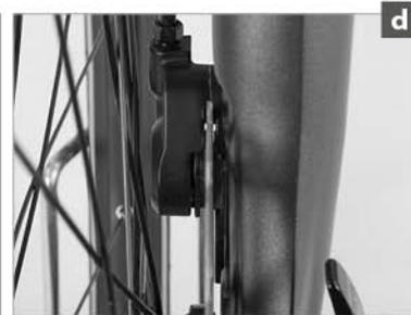
Una volta terminata la regolazione verificate il funzionamento e, rilasciando la leva del freno e lasciando girare la ruota, verificate che le pastiglie non sfreghino (c+d).
