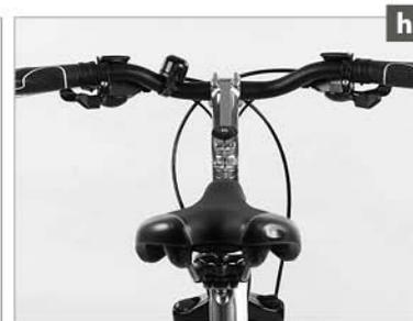
Verificate costantemente la sede stabile del reggisella tenendo ferma la sella con entrambe le mani e provando a girarla (a). Nel caso il reggisella non fosse stabile, è necessario serrare ancora di mezzo giro e con cautela la vite di bloccaggio e verificarne di nuovo la sede.
