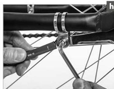
Quindi, stringete i dadi della ruota con una coppia di bloccaggio di 35 Nm (a) e la vite della fascetta del braccio del freno con una coppia di bloccaggio di 3-4 Nm.
