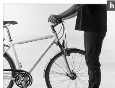
Per verificare la scorrevolezza della serie sterzo, sollevate con una mano il telaio in modo che la ruota anteriore non sia più a contatto con il suolo. La ruota anteriore deve oscillare da un estremo all'altro in maniera scorrevole e senza bloccarsi. Toccando leggermente il manubrio, la forcella deve svitarsi automaticamente dalla posizione centrale (g).
