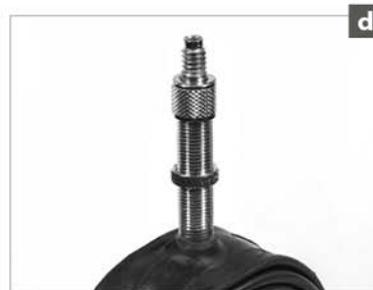
Le camere d'aria con **valvola Schrader**, nonché **Dunlop** e **Presta** (con adattatore speciale), possono essere gonfiate dal benzinaiolo per mezzo di un compressore. Usate il compressore con colpi brevi per non immettere troppa aria nello pneumatico che altrimenti potrebbe scoppiare. Per far fuoriuscire aria basta premere il perno al centro della valvola Schrader (e) o brevemente verso l'interno il dado zigrinato della valvola Presta (f).
