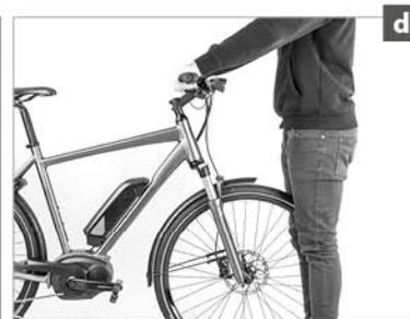
4. Compruebe que el manillar y la potencia no se han torcido ni empezado a romperse y siguen rectos. Asegúrese de que la potencia continúe bien apretada en la horquilla, intentando girar el manillar con respecto a la rueda delantera (d). Apóyese un momento sobre las palancas de freno o las palancas de freno/cambio para comprobar la sujeción segura del manillar en la potencia.
