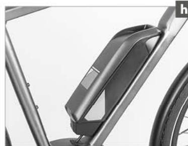
7. Haga rebotar la Pedelec contra el suelo a poca altura y trate de identificar el origen de eventuales ruidos. En este caso, inspeccione los rodamientos, los tornillos y la colocación correcta de la batería (h, pág. 31) y los conectores (a+b).
