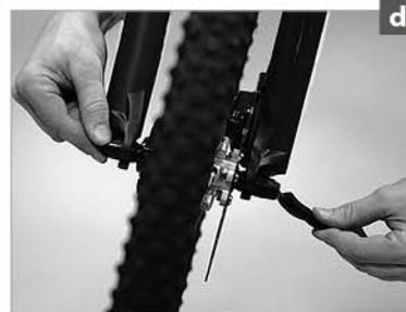
Per facilitare lo smontaggio della ruota posteriore spostate con la mano il cambio leggermente all'indietro (f). Sollevate di poco la bicicletta e date un colpo alla ruota per farla cadere.
