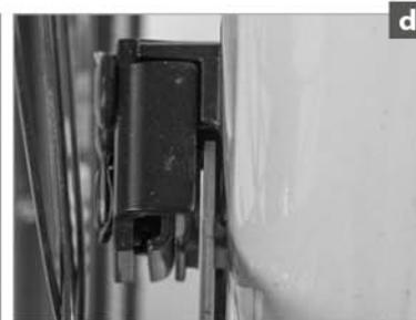
Regolazioni ripetute modificano la posizione della leva sulla pinza del freno. L'efficacia del freno diminuisce. In casi estremi il freno può bloccarsi completamente. **Pericolo d'incidente!**
