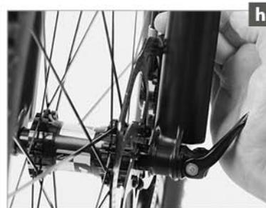
Quando il filetto del perno passante è completamente svitato dal filetto dei tubi è possibile rimuovere completamente il perno passante.
