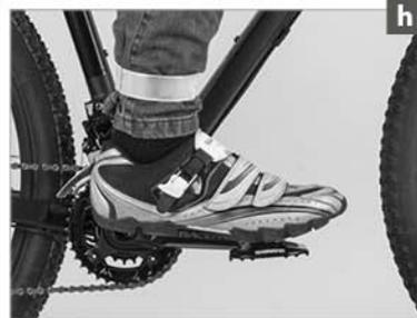
Il vantaggio principale dei pedali automatici (a) è dato da una tenuta stabile del piede durante pedalate veloci o uscite su fondo accidentato. Grazie alla tenuta fissa il pedale può essere spostato o tirato.
