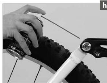
Quindi esercitate più volte pressione sul carro posteriore (a) ed eliminate il lubrificante in eccesso con un panno pulito prima dell'uscita successiva.
